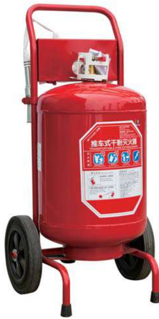
MFZ/ABC 50kg 推车式干粉灭火器 外径: 406mm 最大工作压力: 1.2Mpa 环境温度: -20℃ ~ +55℃ 测试压力: 2.1Mpa 最小壁厚: ≥ 1.3mm 材质: 碳钢 灭火等级: 10A233B 采用标准: CCS/ZY/EC MFZ/ABC 50kg WHEELED POWDER FIRE EXTINGUISHER Diameter: 406mm Maximum working pressure: 1.2Mpa Ambient temperature: -20℃ ~ +55℃ Test pressure: 2.1Mpa Minimum wall thickness: ≥ 1.3mm Material: Carbon Steel Fire Rating: 10A233B Standard: CCS / ZY / EC
